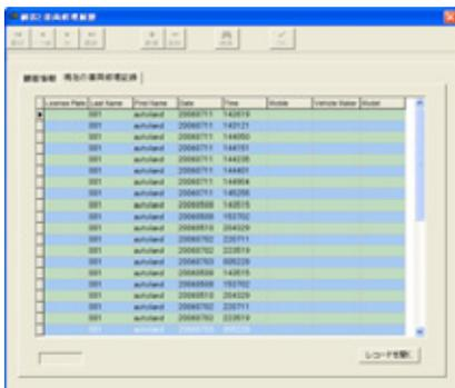
現在診断している車両の修理履歴が表示されます。表示させたいレコードをダブルクリックすると「車両修理履歴」画面が表示され、録画されたデータを見ることができます。
